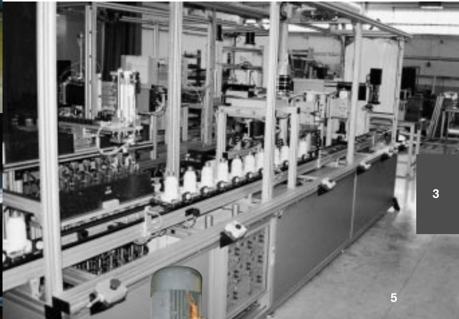
5/ Montageanlage für Lithiumzellen · Assembly facility for lithium cells · Installation de montage de cellules en lithium · Impianto di montaggio per cellule di litio · Instalación de montaje para celdas de litio
